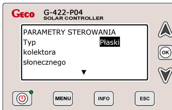
Rys. 5. Obraz ekranu, który pojawia się podczas edycji parametrów sterowania. (Podświetlonym parametrem do zmiany na ekranie jest wybór typu kolektora)
